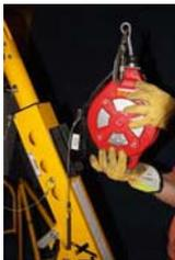
5. Installare il cavo o la fune di sicurezza o l'argano sulla staffa di montaggio preposta a supportare il dispositivo di sollevamento, quindi bloccare con il perno attaccato alla staffa dell'argano o al dispositivo retrattile con funzione di recupero.
