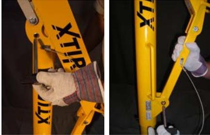
4. Fissare tutto con il primo perno a manopola, quindi installare la gamba inferiore del braccio pescante tra gli occhielli del palo e bloccare con il secondo perno a manopola.
