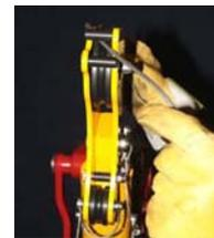
7. Nel caso in cui sia richiesta l'installazione dell'argano per materiali, utilizzare la staffa di montaggio inferiore posizionata sotto il braccio pescante. Installare l'argano sulla staffa di montaggio e bloccare con il perno attaccato all'argano. (A) Rimuovere il perno piccolo per il fissaggio della puleggia. Posizionare il cavo sulla puleggia e re-installare la puleggia utilizzando il perno di fissaggio (B).
