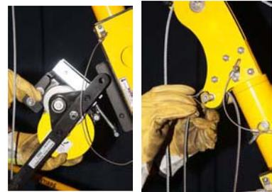
**ATTENZIONE:** è severamente proibito utilizzare l'argano per materiali come dispositivo anticaduta, quando esso è posizionato sulla staffa di montaggio inferiore posizionata sotto il braccio pescante
