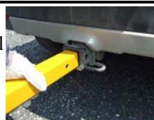
3. Stabilizzare il tubo o un qualsiasi adattatore certificato, approvato, raccomandato dal produttore, bloccando il ricevitore con il perno di fissaggio
