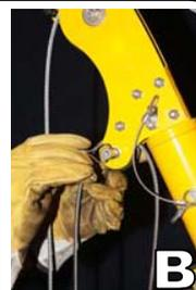
**ATTENZIONE:** è severamente proibito utilizzare l'argano per materiali come dispositivo anticaduta, quando esso è posizionato sulla staffa di montaggio inferiore posizionata sotto il braccio pescante
