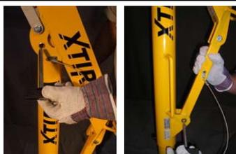
7. Fissare tutto con il primo perno a manopola (A), quindi installare il braccio inferiore del braccio pescante tra gli occhielli del palo, quindi fissare con il secondo perno a manopola (B)
