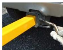
**ATTENZIONE:** prima di ciascun utilizzo, verificare che il sistema sia bloccato. Per stabilizzare il sistema, verificare che il perno di fissaggio sia correttamente posizionato
