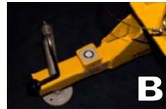
5. Inserire il palo nell'adattatore stabilizzatore e il perno in posizione corretta
