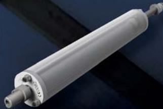
L'assorbitore riduce l'energia cinetica trasmessa ai supporti. L'energia viene dissipata dalla sfera che attraversa il cilindro in EPDM contenuto all'interno del carter protettivo. Il cilindro in gomma deve essere sostituito in caso di entrata in funzione del sistema. Svolge anche la funzione di tenditore per il corretto posizionamento del cavo. La barra filettata M16x200 funge anche da tenditore una volta inserita nell'art. AP15.
