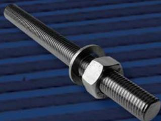
I fissaggi M16 servono per ancorare i supporti secondo le rispettive geometrie alla struttura portante della copertura, sia essa in conglomerato cementizio armato, legno o acciaio. Possono essere inseriti direttamente nella copertura con resina vinilestere bicomponente o con contropiastre.
