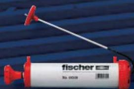
La pompette si utilizza durante le operazioni di posa per la pulizia dei fori. Dopo aver praticato un foro sulla copertura con un trapano a rotopercolazione, è necessario pulirlo con l'apposito scovolino e successivamente con la pompette per eliminare tutti i residui di polvere dalle pareti del foro e permettere alla resina di aderire meglio.
