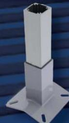
Si utilizza come supporto per qualsiasi componente della linea. Il sostegno si compone di una base a bicchiere con una base sagomata a capanna per coperture con pendenza al 30%. All'interno della base si inserisce una prolunga in alluminio solidarizzata al di sotto del bicchiere mediante 4 viti autofilettanti 6.3x45mm. L'insieme è reso impermeabile da una guarnizione in mousse adesiva.
