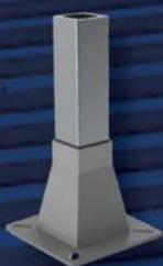
Si utilizza come supporto per qualsiasi componente della linea. Il sostegno si compone di una base a bicchiere con una superficie laterale a tronco piramidale all'interno della quale viene inserita una prolunga in alluminio solidarizzata alla base mediante 4 viti autofilettanti 6.3x45mm. L'insieme è reso impermeabile da una guarnizione in mousse adesiva.
