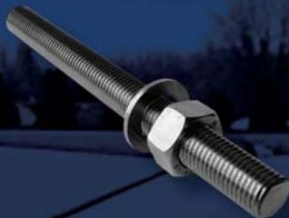
I fissaggi M12 servono per ancorare i supporti secondo le rispettive geometrie alla struttura portante della copertura, sia essa in conglomerato cementizio armato, legno o acciaio. Possono essere inseriti direttamente nella copertura con resina vinilestere bicomponente o con contropiastre.
