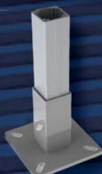
Si utilizza come supporto per qualsiasi componente della linea. Il sostegno si compone di una base a bicchiere all'interno della quale viene inserita una prolunga in alluminio solidarizzata al di sotto del bicchiere mediante 4 viti autofilettanti 6.3x45mm. L'insieme è reso impermeabile da una guarnizione in mousse adesiva.
