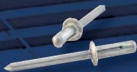
Fissaggio ideale per unire materiali morbidi e morbidi e rigidi. Rivetto con corpo in alluminio munito di guarnizione e chiodo in alluminio. Durante l'applicazione, il corpo del rivetto si tripartisce in modo uniforme: la formazione di 3 nastri garantisce una migliore distribuzione del carico di estrazione e il coinvolgimento di un più ampia superficie nella deformazione del supporto. Il rivetto viene installato in un pre-foro da 8mm
