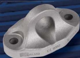
Dispositivo di ancoraggio di TIPO A omologato per l'utilizzo contemporaneo di due operatori, installabile in piano, a parete, a soffitto e su superfici inclinate. Il dispositivo di ancoraggio può essere utilizzato per l'aggancio di linee vita temporanee (la resistenza del dispositivo di ancoraggio è superiore a 30 kN in tutte le direzioni spaziali).
