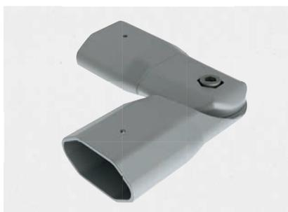
Rinvio d'angolo in alluminio pressofuso per i cambi di direzione orizzontali. Ricalca la sagoma del corrimano e al suo interno vanno inserite e fissate le estremità tagliate del corrimano.
