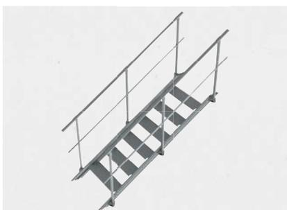
Le sezioni da 25cm che costituiscono i piani di camminamento della passerella vengono utilizzate come gradini, mentre il profilato in alluminio è lavorato in modo da adattarsi a qualunque pendenza compresa tra i 40° e i 65°.
