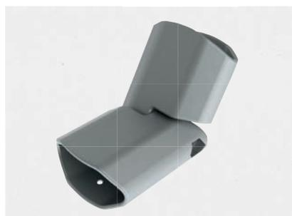
Rinvio d'angolo in alluminio pressofuso per i cambi di direzione verticali. Ricalca la sagoma del corrimano e al suo interno vanno inserite e fissate le estremità tagliate del corrimano.
