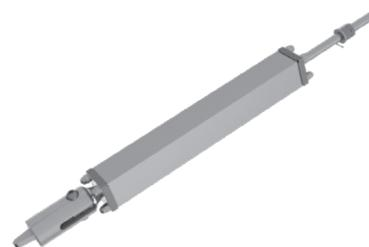
L'assorbitore di energia/tenditore permette di ridurre l'energia cinetica in caso di caduta degli operatori connessi alla linea. È composto da 164 innovative molle a tazza dim. 45x22.4x1.25mm (DIN 2093) sottoposte ad uno speciale trattamento e disposte in 41 coppie. Ogni caduta o entrata in servizio della linea è segnalata dalla rottura della piccola fune posta vicino alla griffa fermacavo.
