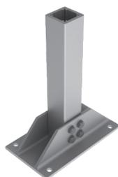
Si utilizza come supporto per elementi terminali e di rinvio d'angolo. E' composto da un'estrusione d'alluminio a sezione quadrata unita ad una base piatta mediante 4 bulloni. La base è fornita con 4 fori di fissaggio  $\varnothing$  18mm.
