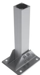
Si utilizza come supporto per elementi intermedi. E' composto da un'estrusione d'alluminio a sezione quadrata unita ad una base piatta mediante 4 bulloni. La base viene fornita con 4 fori di fissaggio  $\varnothing$  18mm.
