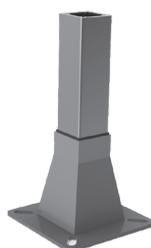
Si utilizza come supporto per qualsiasi componente della linea. Il sostegno si compone di una base a bicchiere con una superficie laterale a tronco piramidale all'interno del quale viene inserita una prolunga in alluminio solidorizzata sotto la base mediante 4 viti autofilettanti 6.3x45mm. L'insieme è reso impermeabile da una guarnizione in mousse adesiva.
