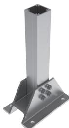
Si utilizza come supporto per elementi intermedi. E' composto da un'estrusione d'alluminio a sezione quadrata unita ad una base universale mediante 4 bulloni. La base è fornita con 4 fori di fissaggio  $\varnothing$  18mm.
