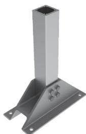
Si utilizza come supporto per elementi terminali e di rinvio d'angolo. E' composto da un'estrusione d'alluminio a sezione quadrata unita ad una base universale mediante 4 bulloni. La base è fornita con 4 fori di fissaggio  $\varnothing$  18mm.
