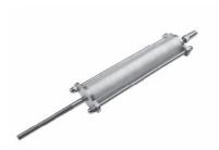
Consente di ridurre l'energia cinetica in caso di caduta e attutire il colpo. In caso di caduta una biglia in acciaio inox attraversa un cilindro in gomma NR85shA posto all'interno del carter di protezione rendendo necessaria la sostituzione del cilindro in gomma. Svolge anche la funzione di tenditore per il corretto posizionamento del cavo ed è dotato del nuovo sistema di bloccaggio rapido "quick fix". Venduto solo all'interno dei kit
