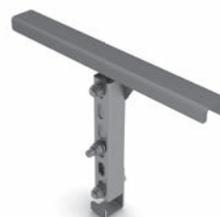
Si utilizza per l'installazione degli elementi guida cavo in posizione centrale sui pioli delle scale. E' costituito da 3 parti, viene fissato su due pioli ed è regolabile in modo da potersi adattare alle varie distanze e dimensioni degli stessi.
