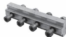
L'elemento di giunzione viene impiegato per collegare due tratti consecutivi del binario. È ricavato da una estrusione d'alluminio con sezione a croce che viene innestata all'interno della sezione cava del binario. Si fissa tramite le viti di bloccaggio.
