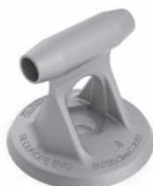
Disposto regolarmente lungo la linea, ogni 12m, mantiene il cavo teso. L'elemento può essere montato sia centralmente sui pioli delle scale con i supporti NSV017 sia lateralmente sui montanti, con le pinze di fissaggio NSV006, e può essere direttamente presato sul cavo.
