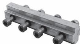
L'elemento di giunzione viene impiegato per collegare due tratti consecutivi del binario. È ricavato da una estrusione d'alluminio con sezione a croce che viene innestata all'interno della sezione cava del binario. Si fissa tramite le viti di bloccaggio.
